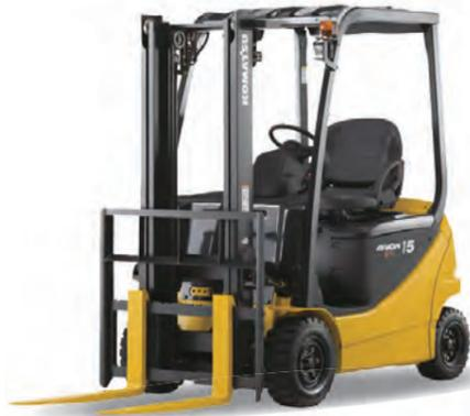
倉庫で日常使用しているフォークリフトを利用して非常時の事業継続に必要な電源を確保します。フォークに積まれているバッテリーは高容量で非常用電源として適しています。
